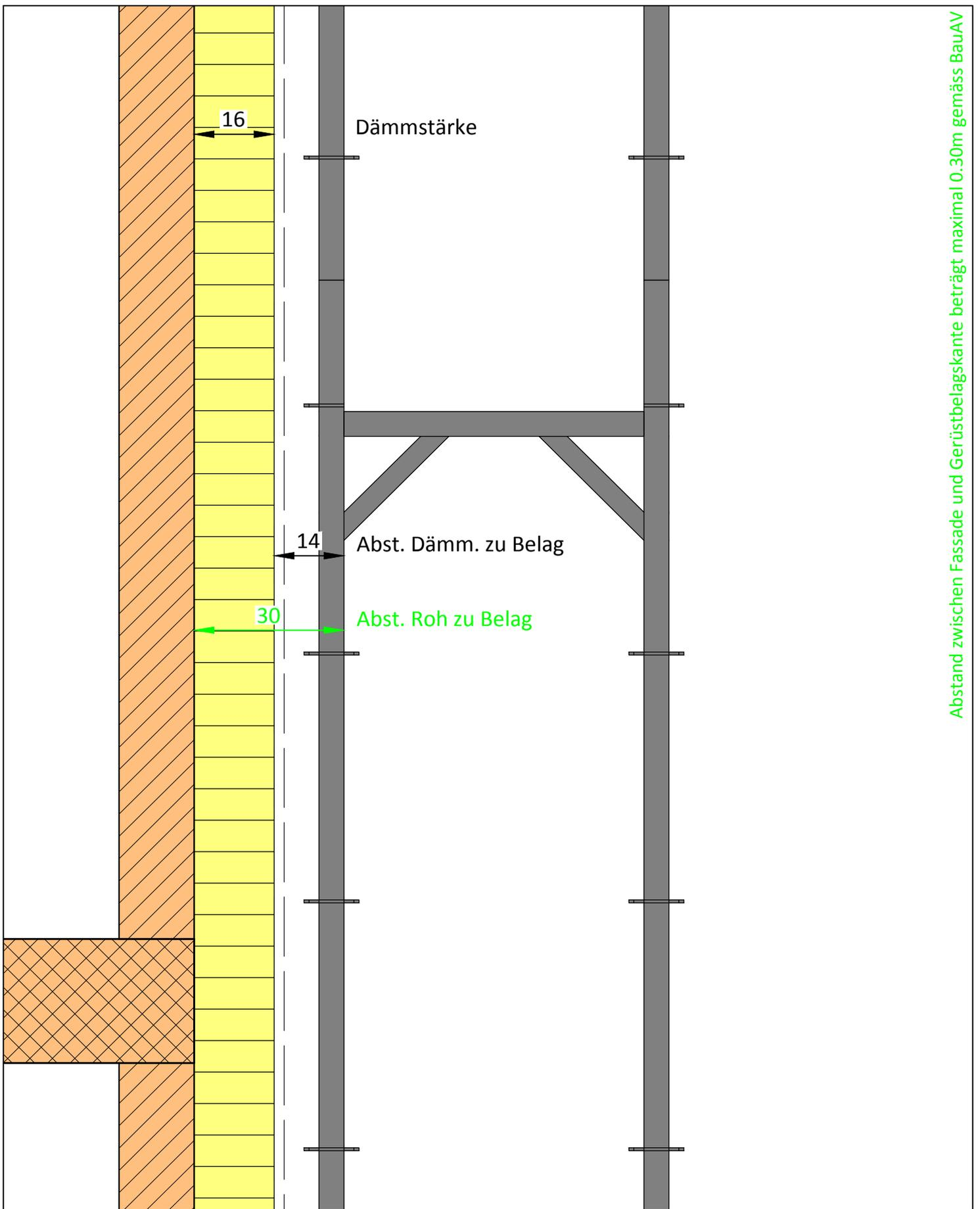
Gerüstabstand zu Fassade bei Wärmedämmung **16 cm**
