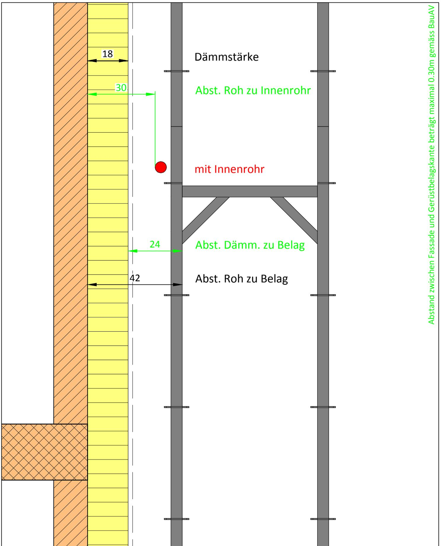
Gerüstabstand zu Fassade bei Wärmedämmung **18 cm**
