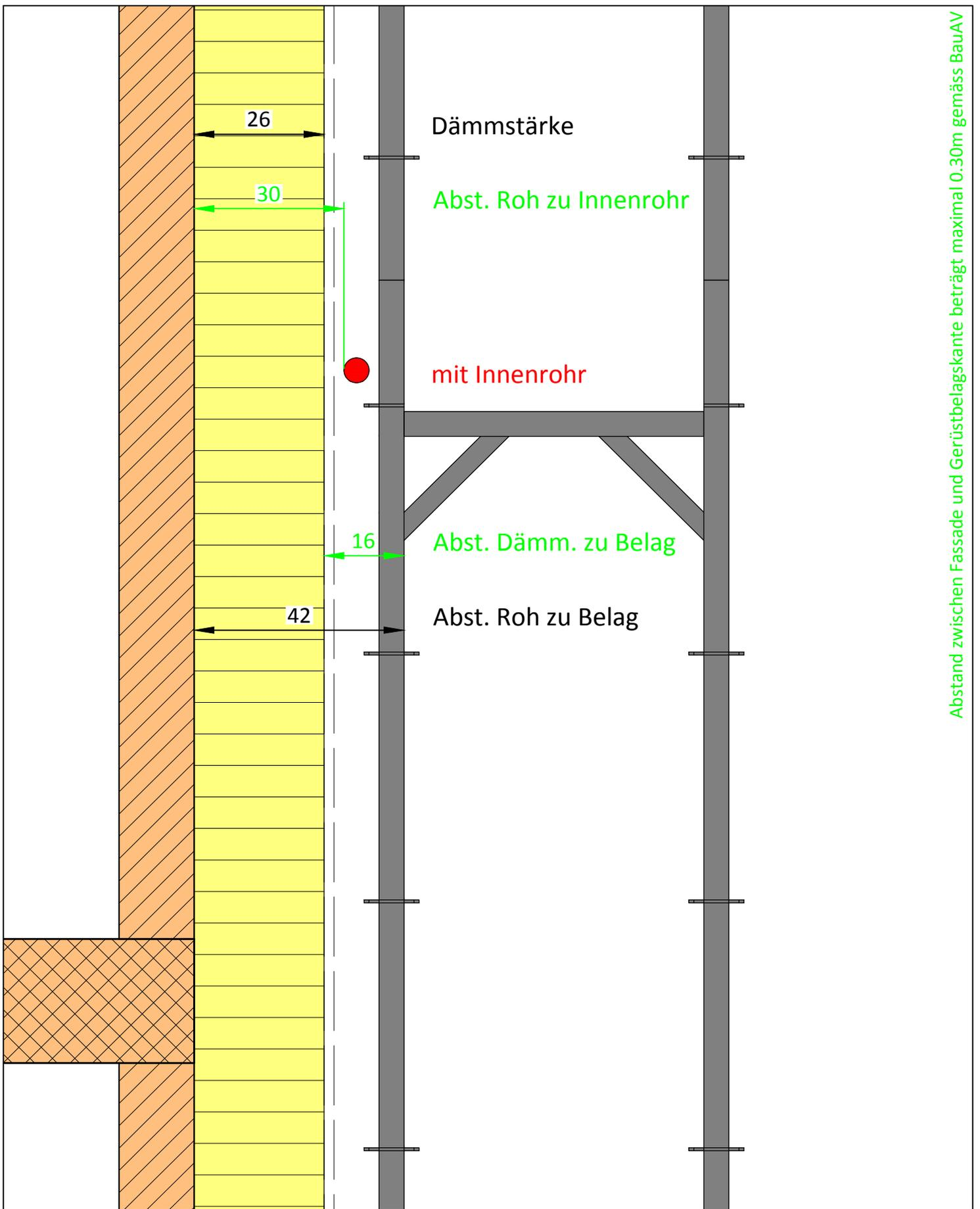
Gerüstabstand zu Fassade bei Wärmedämmung **26 cm**
