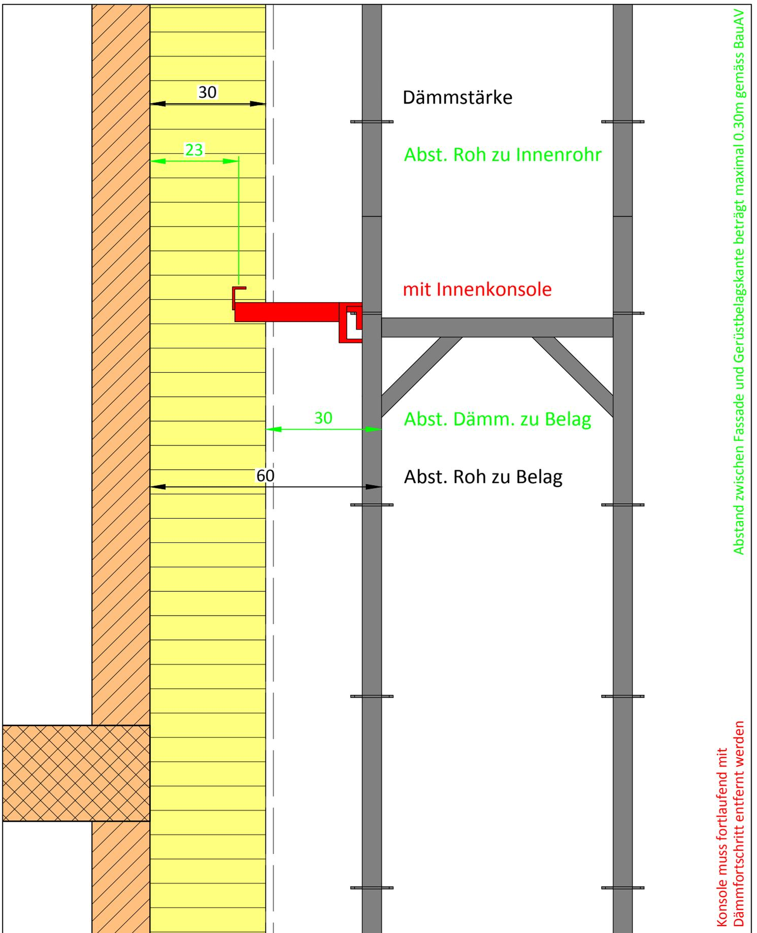
Gerüstabstand zu Fassade bei Wärmedämmung **30 cm**
