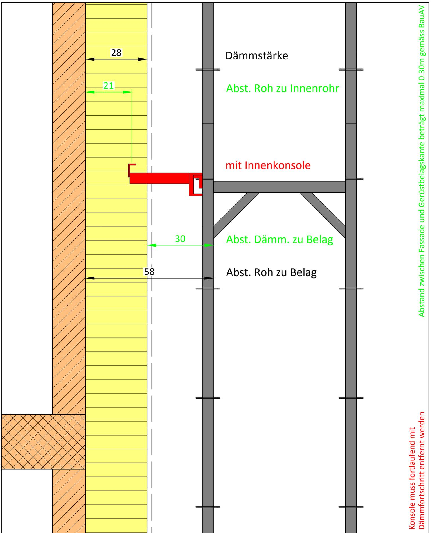
Gerüstabstand zu Fassade bei Wärmedämmung **28 cm**
