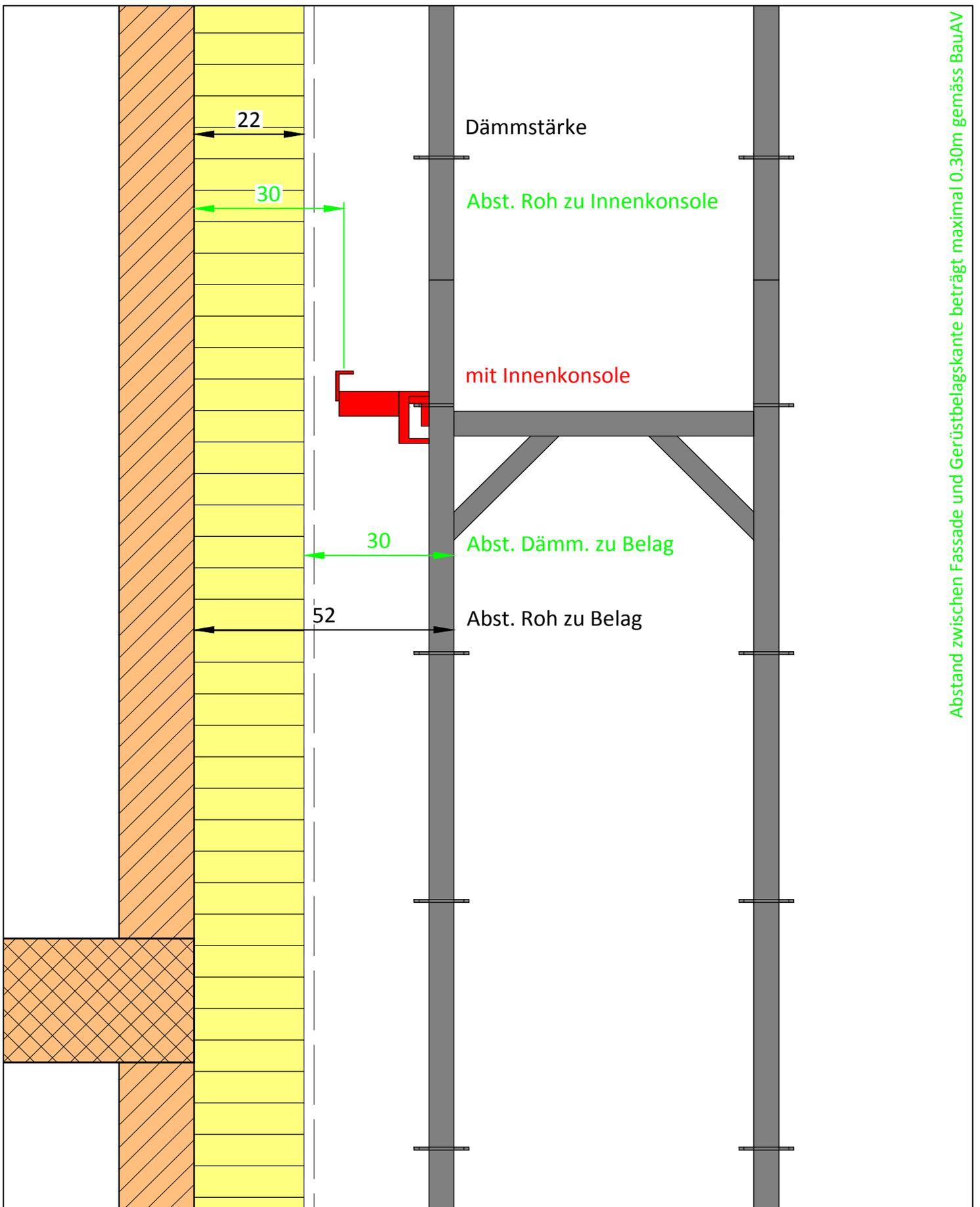
Gerüstabstand zu Fassade bei Wärmedämmung **22 cm**
